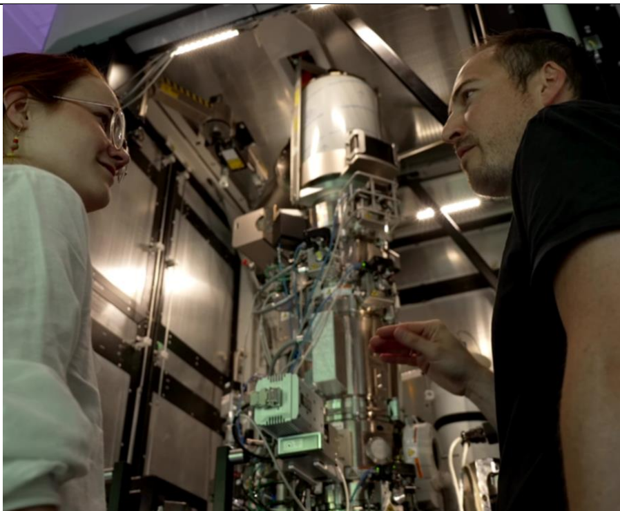
Lars demonstrerer Topsoes elektronmikroskop. Elektronerne trækkes ud øverst i cylinderen og accelereres så ned gennem det lange rør, hvor elektronbølgen til sidst rammer den prøve, vi vil analysere. Inde i røret er der vakuum, da elektronerne ved sammenstød med partikler ville blive spredt.
