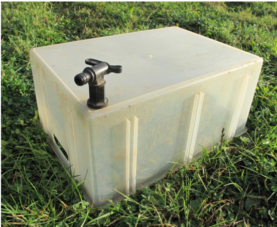
5-02 En kasse til opsamling af methan i en muddergrøft. Find en hane til plastkassen, der kan tåle varmen fra gasflammen.
