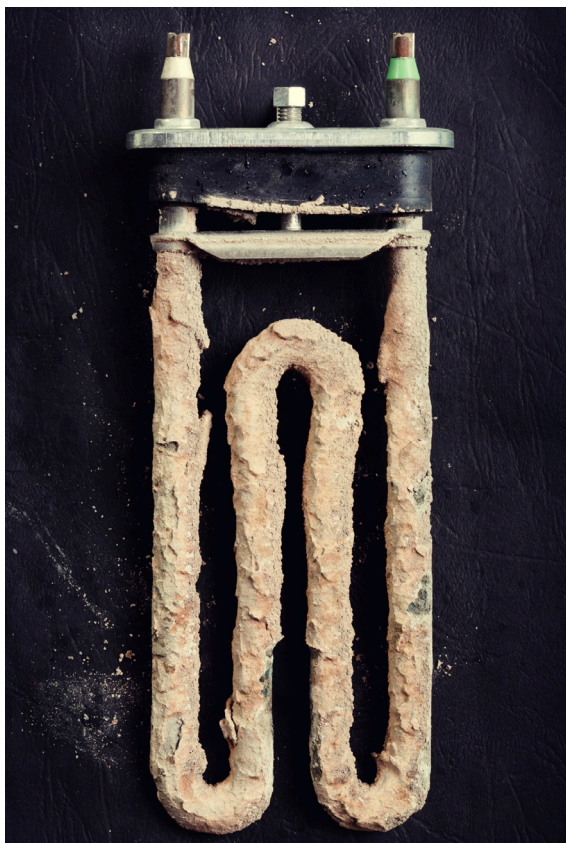
3.15 Tilkalket varmelegeme i vaskemaskine. Belægningen består af calciumcarbonat (kalk, \text{CaCO}_3 ).
