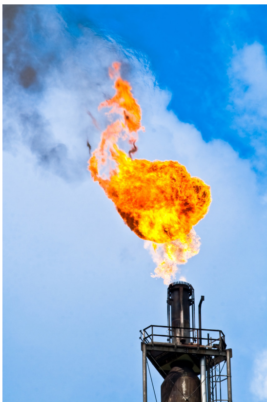
Flaring. En gasflamme brænder altid over f.eks. olieraffinaderier for at sikre, at overskydende gas uskadeliggøres.
