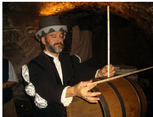
Opmåling af vintønde med planimetrisk visieroute (Kilde: Adam-Ries-museum, billede fra vinkælderen bygget ca. 1500). Annaberg-Buchholz, Tyskland (grænsen mod Tjekkiet).
