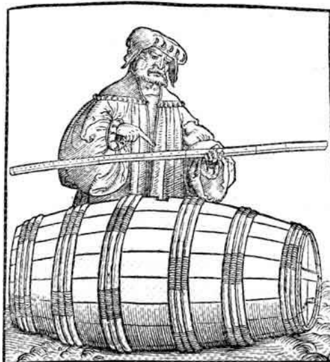
Opmåling af vintønder (Kilde ukendt). Vintønden opmåles med en målestok. (se yderligere: www.keplerraum.at )
